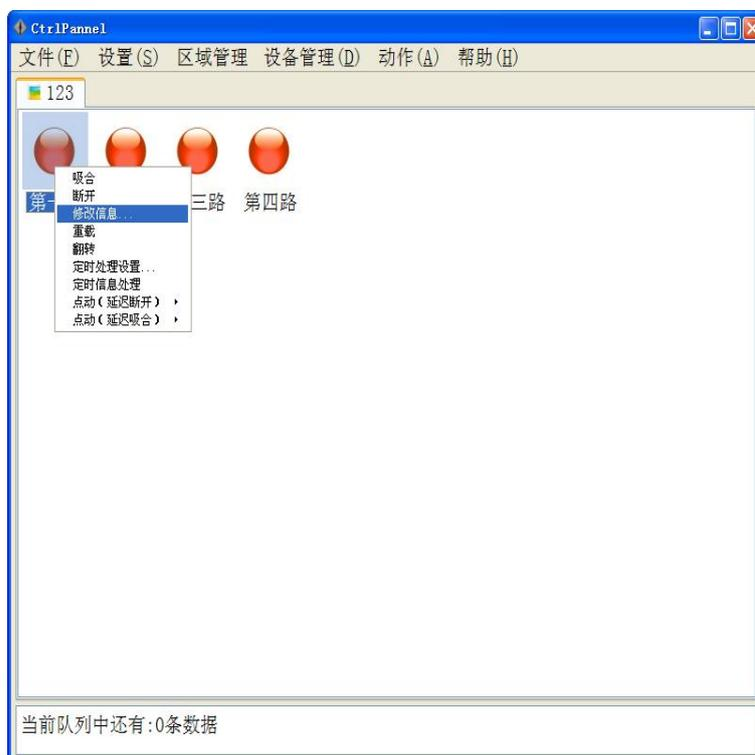
设置点动（延时吸合或延时断开），延时时间可以自定义，操作如下所示：
