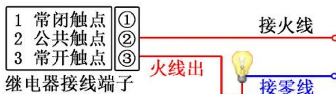
(3) 以网络控制 6 路输入输出模块为例，接线图如下：
