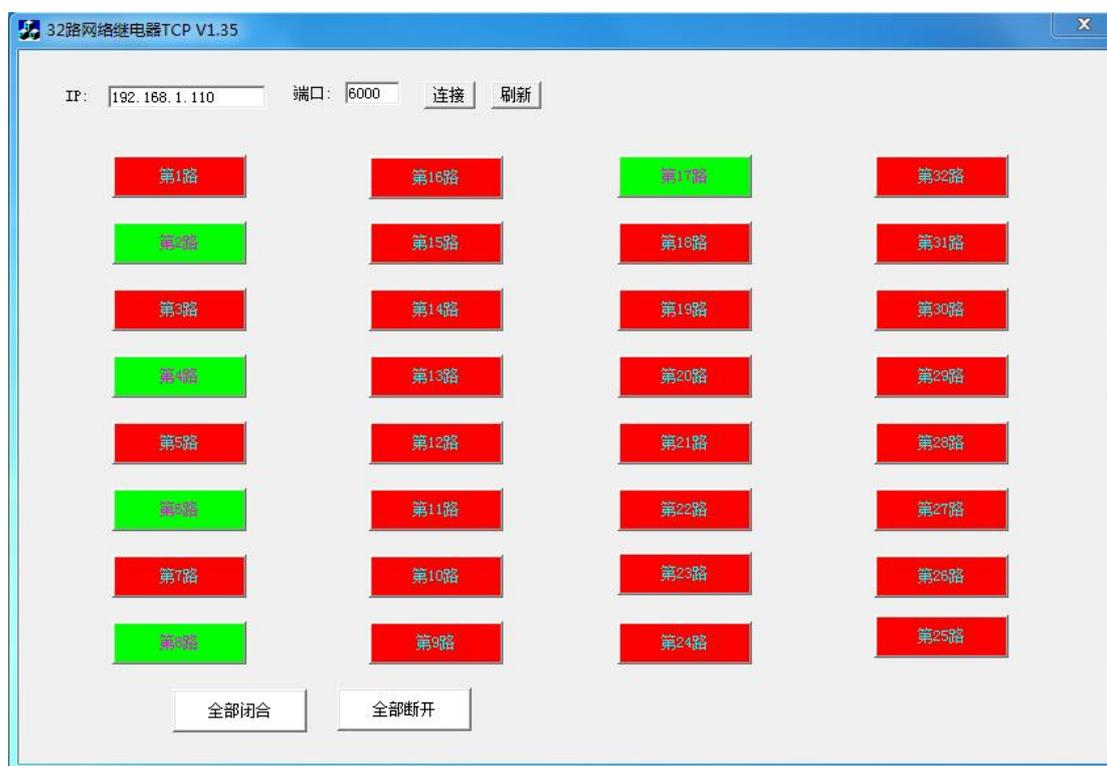
输入输出产品，1-16 路代表 1-16 路继电器输出，17-32 路代表 1-16 路输入。上图为继电器控制板与软件连接成功后图示，软件可以控制继电器动作，也可以显示输入和输出的
