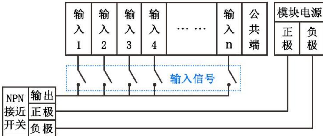
(3) DC5-24V 有源输入接线图解
