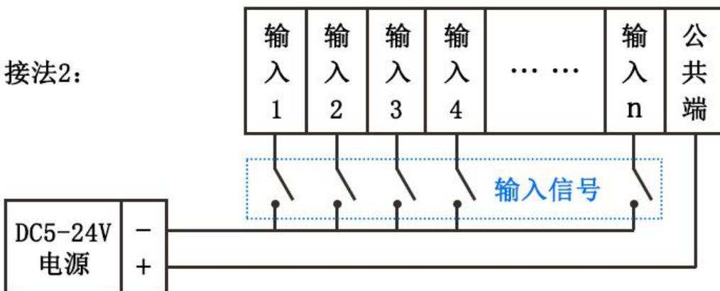
(4) PNP 接近开关接线图解
